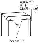
ヘッドボードにガタツ キがある場合は、ヘッ ドボード裏の取付ネジ を付属の六角棒レンチ (幅4)で増し締めして ください。
