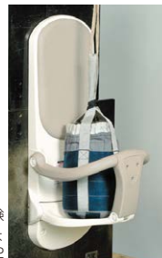
砂袋の繰り返し落下試験 ※写真は Combi ベビーキープスリムW62
