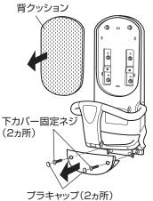
②プラスドライバー No.3を使用 して本体固定ネジ(8ヵ所)を はずし、コーナー金具から本体 を取りはずします。
