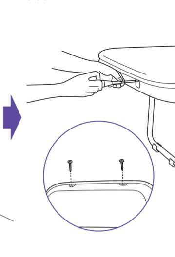
④テーブルを収納しテーブル部左右のマット固定ネジ(2カ所)を固定。
