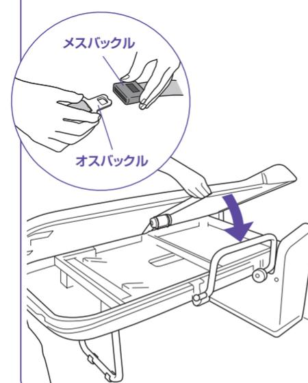
③テーブル先端部のテーブル固定ネジ(2カ所)を固定し、緩みのないことを確認。
