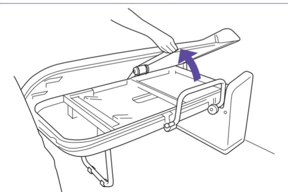
5 【ベルト交換の場合】オスパックルのベルトをゆっくりと巻取らせた後、固定ネジ(1カ所)をはずす。
