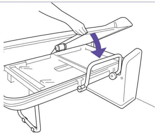
10 テーブル先端部のテーブル固定ネジ(2カ所)を固定し、緩みのないことを確認。
