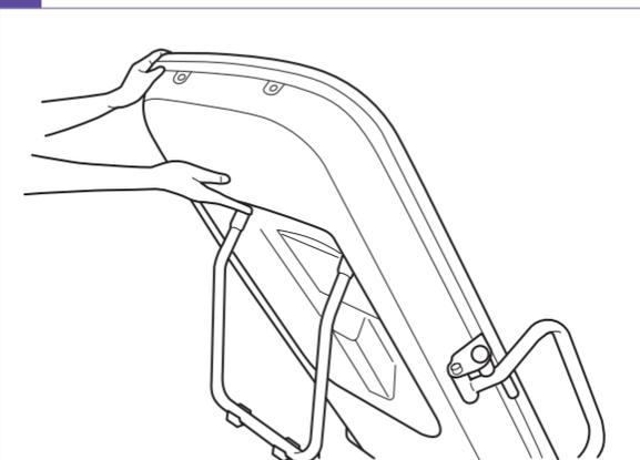
3 テーブル先端部のテーブルカバー固定ネジ(2カ所)をはずす。ベルトのオス・メスパックルをあわせて固定する。
