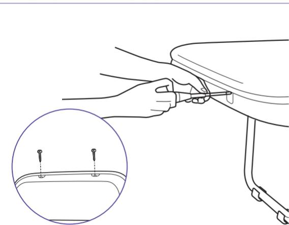
11 テーブルを収納しテーブル部左右のマット固定ネジ(2カ所)を固定。
