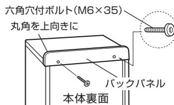
バックパネルはざぐりのある面から、付属の六角棒スパナを使用し、六角穴付ボルト(M6×35)2本で本体裏面に取り付けてください。(2カ所)
