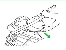
④シート位置が3段階で止まらず水平に近い場合や、下側に回転する場合は異常な状態です。ただちにご使用を中止し、コンビウィズ㈱サービスセンターにご連絡ください。
