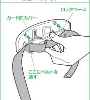
4 左右のベルトをそれぞれ、ガードの穴に 通し、ガード前カバーをガードに組付ける。
