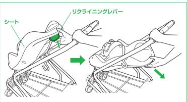
①リクライニングレバーを上げ、ロックがはずれることを確認し、そのまま シートを下げてリクライニング(3段階)することを確認してください。
