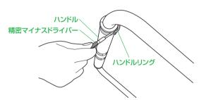
精密マイナスドライバーの先端をハンドルリングの すき間に差し込むと簡単にはずれます。
