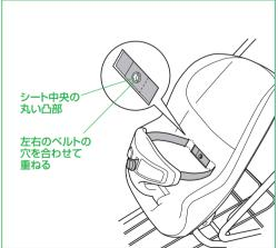
7 ベルトカバーをシートに組付け、ベルトカバー固定六角穴付ボルト(ネ ジゆるみ止め剤付きの新しいボルト)、袋ナット(再利用)で固定する。
