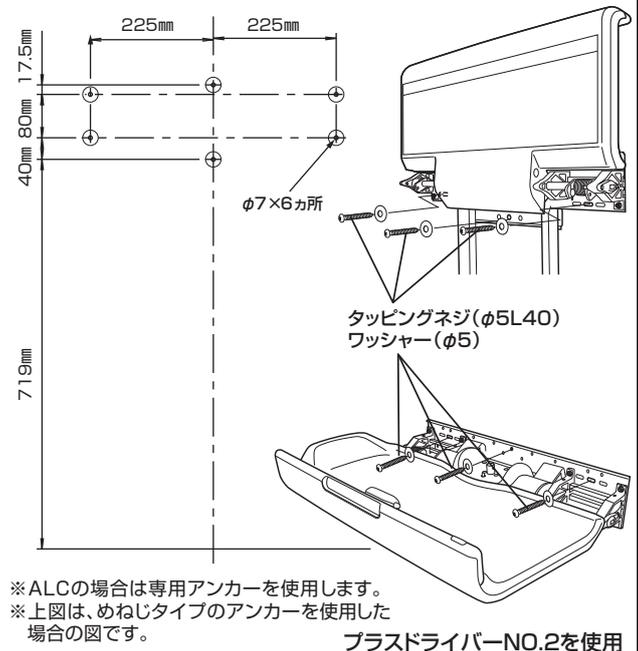
6 脚カバーを取付け、その後ヒンジカバー(左右)、センターカバー上の順で本体に取り付けます。
