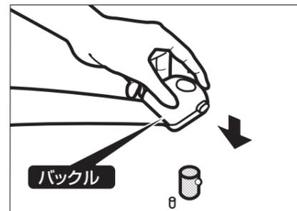
③バックル側面のボタンを押すとはずれます。
