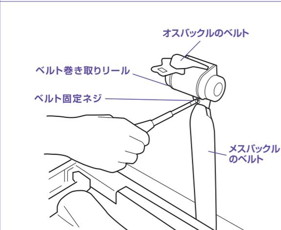
6 【ベルト交換の場合】オスパックルのベルトとともにメスパックルのベルトをはずす。
