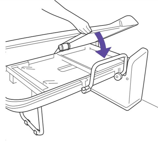
10 テーブル先端部のテーブル固定ネジ(2カ所)を固定し、緩みのないことを確認。
