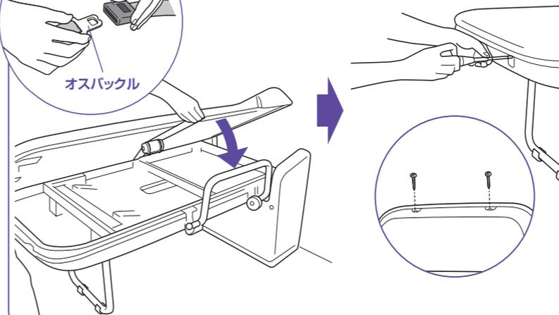
④テーブルを収納しテーブル部左右のマット固定ネジ(2カ所)を固定。
