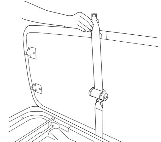
9 マット【マット交換の場合は新しいマット】を左側を軸にして倒す。
