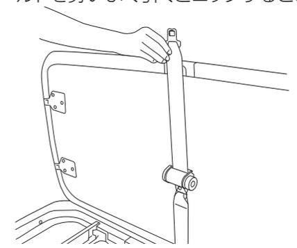
②ベルト固定ネジの脱落、ゆるみの確認。
